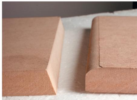
Die untere Schnittkante von Brett 1 erhält nur auf der abgewandten Seite eine Rundung, da auf der anderen Seite Brett 3 flächig anstößt. Brett 2 ist mit 15 Grad gewinkelt, um sich dem schrägen Verlauf von Brett 1 besser fügen zu können.
