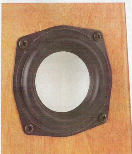
Der kleine Aurasound-Breitbänder ist mit seinem langhubigen Antrieb und der riesigen Sicke zu erstaunlichen Auslenkungen fähig
