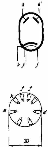
Disposition des électrodes et connexions sur le culot du tube EZ 3.
